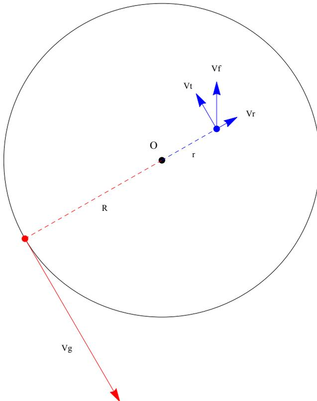
La velocità della folaga  $V_f$  può essere scomposta in  $V_r$ , velocità radiale che avvicina la folaga alla riva, e una velocità tangenziale  $V_t$  che mantiene la gatta in opposizione rispetto al centro.
