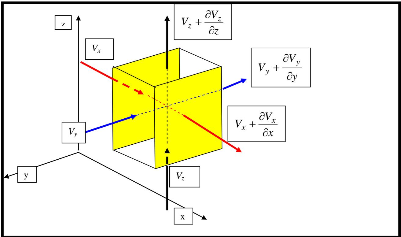
La differenza tra il flusso di  $V_x$  entrante ed uscente dalle facce normali all'asse  $x$ , detta  $\Sigma = dx \cdot dy = dx \cdot dz = dy \cdot dz$  la superficie di una faccia del cubo elementare, è:
