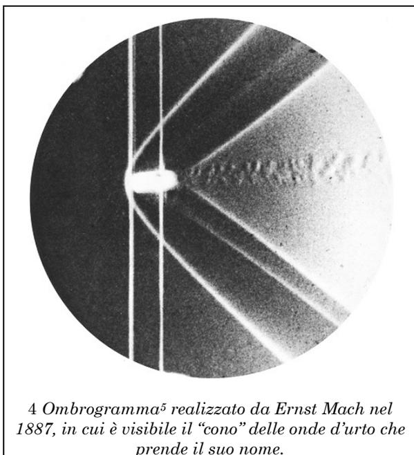
4 Ombrogramma<sup>5</sup> realizzato da Ernst Mach nel 1887, in cui è visibile il “cono” delle onde d’urto che prende il suo nome.
