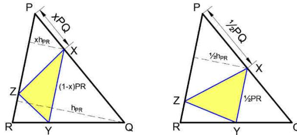
Doc sa cosa accadrà dopo la sua scelta e quindi può fare i calcoli. Indicata con  $x\overline{PQ} = \frac{PX}{PQ}\overline{PQ}$  la posizione di X su PQ, se  $h_{PR}$  è l'altezza del triangolo originario relativa al lato PR, il triangolo XYZ avrà altezza pari a  $xh_{PR}$  e base (XY) pari a  $(1-x)\overline{PR}$ . Possiamo calcolare quindi l'area  $S_{XYZ}$ :
