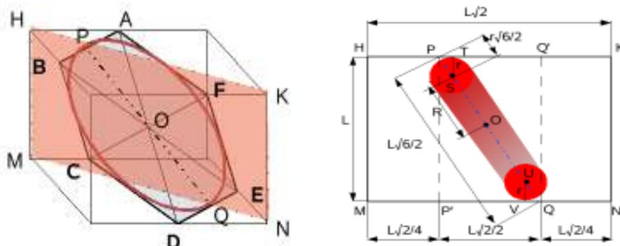
Con un po' di geometria elementare, ed osservando la similitudine fra i triangoli  $PP'Q$  e  $STP$ , si trova la relazione  $R = L \frac{\sqrt{6}}{4} - r \frac{\sqrt{6}}{2} = \frac{\sqrt{6}}{2} \left( \frac{L}{2} - r \right)$ , con  $R > 0$  e  $r < L/2$ .
