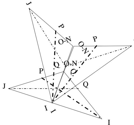
Giusto per chiarezza: le punte  $I$  (o  $J$ ) di due moduli si incastrano nelle falde del terzo; anche se dalla figura non si vede, le linee  $JI$  passano per i punti  $Q$  (o  $P$ ); le "orecchie" che avevamo riaperto al settimo passaggio stanno esattamente all'interno delle falde, quindi nel punto  $O$  si incontreranno le tre facce pentagonali del dodecaedro.
